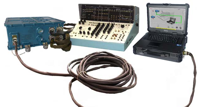
Підключення при перевірці демонтованого блоку
