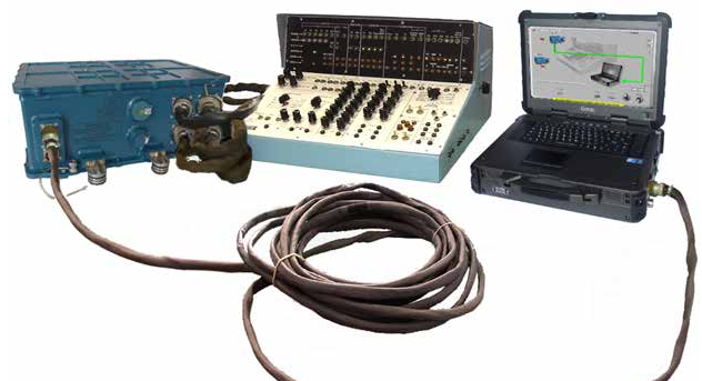
Підключення при перевірці демонтованого блоку
